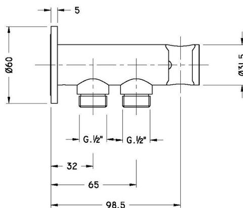
SPAT004 Supporto con presa acqua e valvola di sicurezza attacco esterno
