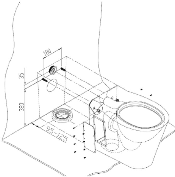
1. Installazione con scarico a pavimento
